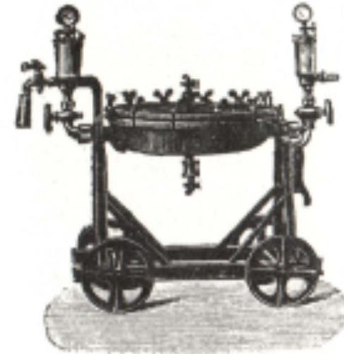
Massenfilter (Cellulose) um 1900
